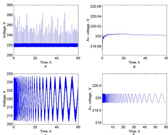
Рис. 5. Модель случайного процесса с периодически скачкообразным изменением математического ожидания (модель 7) (а), модель случайного процесса с аperiodически меняющимся математическим ожиданием (модель 8) (в) и соответствующие им накопленные средние (б, г)
