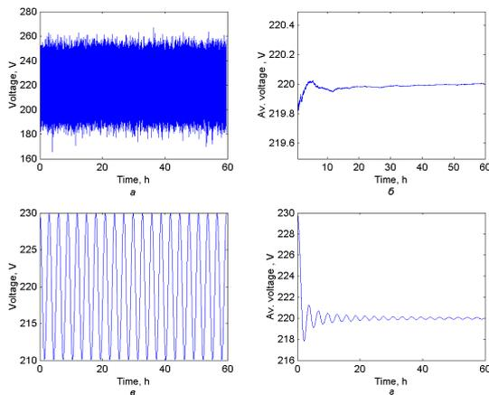
Рис. 2. Модель белого гауссовского шума (модель 1) (а), модель гармонического колебания (модель 2) (в) и соответствующие им накопленные средние (б, г)
