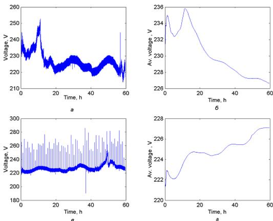
Рис. 1. Изменение во времени напряжения электросети в двух сеансах записи (а, в) и соответствующие им накопленные средние (б, г)
