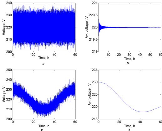
Рис. 3. Модели случайного процесса с высокой (модель 3) (а) и низкой (модель 4) (в) частотой колебания математического ожидания и соответствующие накопленные средние (б, г)
