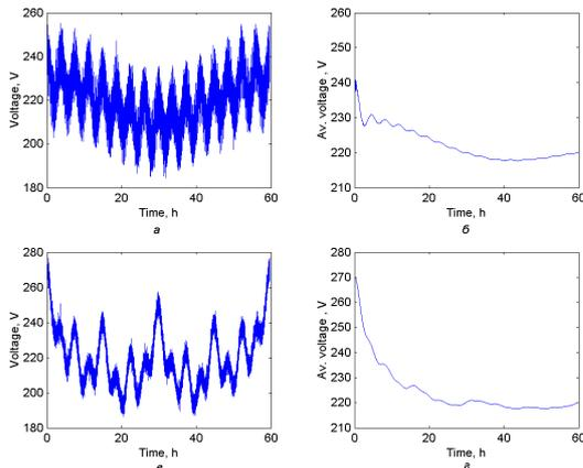
Рис. 4. Модели случайного процесса с математическим ожиданием, содержащим три сильно отстоящих друг от друга по частоте гармоник (модель 5) (а) и пять близко расположенных по частоте гармоник (модель 6) (в), а также соответствующие им накопленные средние (б, г)
