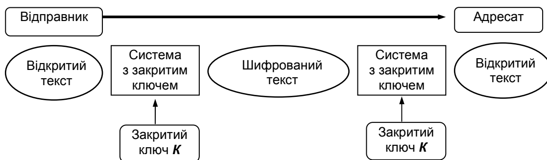
Рис. 2. Схема симетричної криптосистеми
