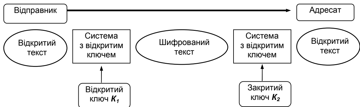
Рис. 1. Схема асиметричної криптосистеми
