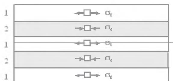
Рис. 1. Двухкомпонентный слоистый композит: 1 – слои первого компонента, включающие два наружных слоя; 2 – слои второго компонента.
