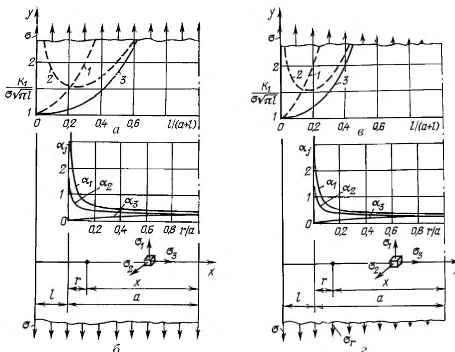
Рис. 2. Коэффициенты интенсивности напряжений для мелких (1), глубоких (2) и промежуточных (3) кольцевых трещин (а, в) и коэффициенты концентрации главных напряжений (б, г) при растяжении (а, б) и изгибе (в, г) цилиндрического бруса.
