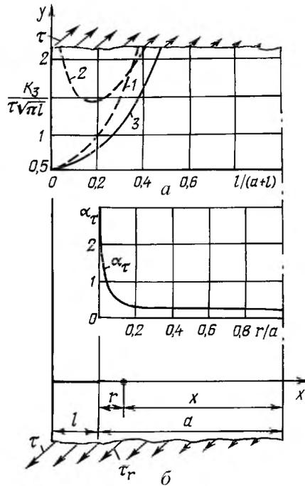
Рис. 3. Коэффициенты интенсивности напряжений для мелких (1), глубоких (2) и промежуточных (3) кольцевых трещин (а) и коэффициенты концентрации касательных напряжений (б) при кручении цилиндрического бруса.
