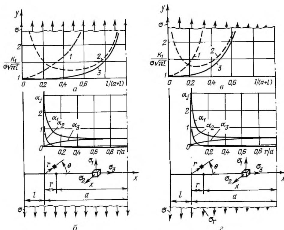
Рис. 1. Коэффициенты интенсивности напряжений для мелких (1), глубоких (2) и промежуточных (3) двухсторонних трещин (а, в) и коэффициенты концентрации главных напряжений (б, г) при растяжении (а, б) и изгибе (в, г) бруса.
