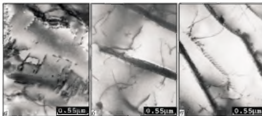
Рис. 3. Дислокационная структура материала, разрушенного в результате усталостных испытаний: a – f = 500 Гц; b – f = 3000 Гц; c – f = 10000 Гц.
