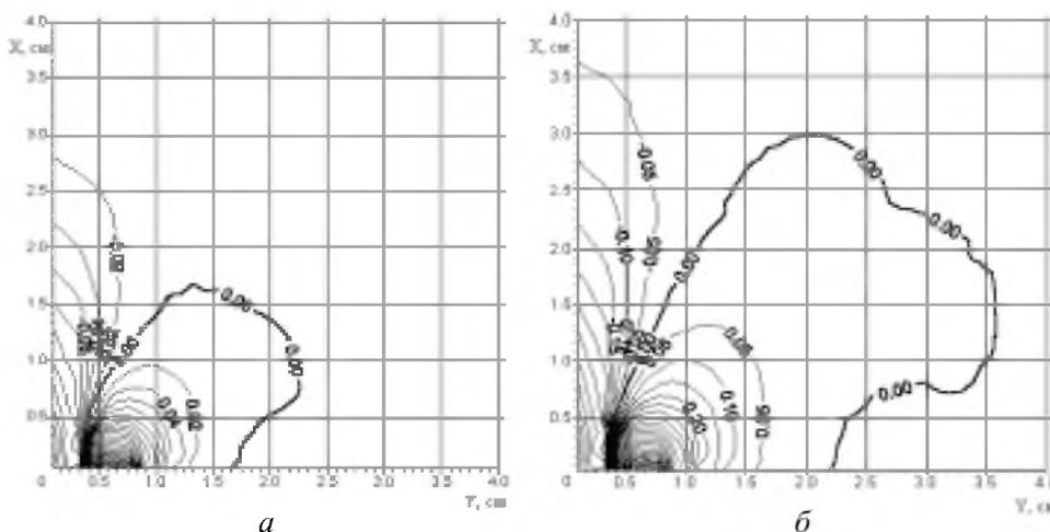
Рис. 1. Распределение плотности избыточной энергии  $\Delta$  [ $10^{-1}$  Дж/м<sup>3</sup>] вблизи вершины трещины при динамическом нагружении со скоростью  $\dot{\sigma} = 5 \cdot 10^5$  МПа/с: а –  $t = 20$  мкс; б –  $t = 30$  мкс.
