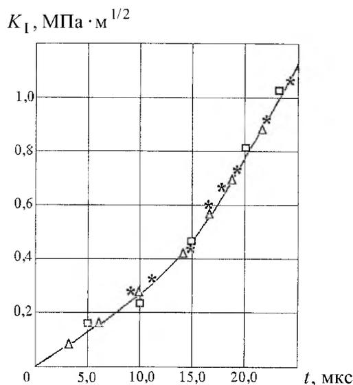
Рис. 4. Изменение коэффициента интенсивности напряжений  $K_I$  при симметричном импульсном растяжении пластины с центральной трещиной.
