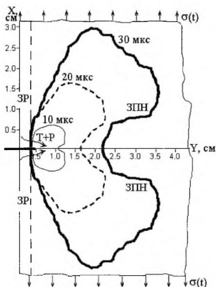
Рис. 2. Схема развития зоны повышенных напряжений при симметричном растяжении стационарной трещины.
