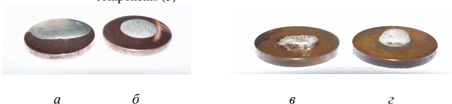
Рис. 5. Натуральные капли припоев ПОС-61 (а, в) и Sn—8% (мас.) Bi (б, з) после исследования смачиваемости в вакууме (а, б) и на воздухе (в, з)
