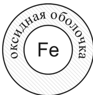
Рис. 3. Схема структуры наночастиц железа, которые были синтезированы в результате термического разложения олеата железа(II).
