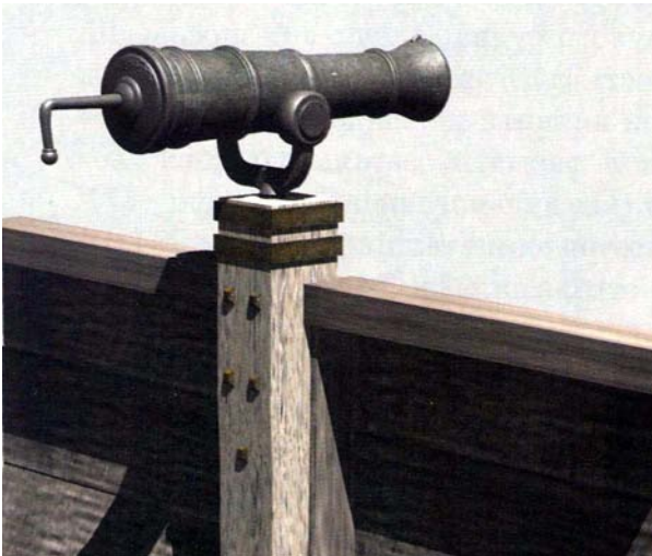
Мал. 4. Бортове кріплення фальконету (реконструкція)
