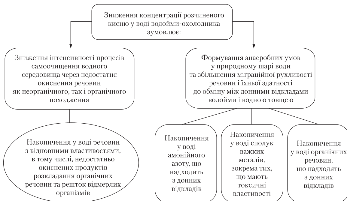
Рис. 3. Зниження інтенсивності самоочищення водного середовища та збільшення концентрації речовин у воді внаслідок надходження з донних відкладів
