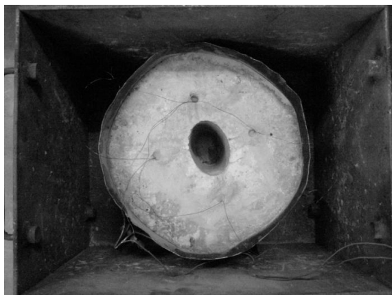
Рис. 3 – Загальний вигляд циліндричної моделі, розташованій в вибуховій камері, до вибуху
