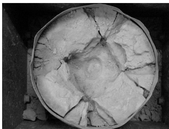
Рис. 4 – Загальний вигляд циліндричної моделі, розташованій в вибуховій камері, після вибуху
