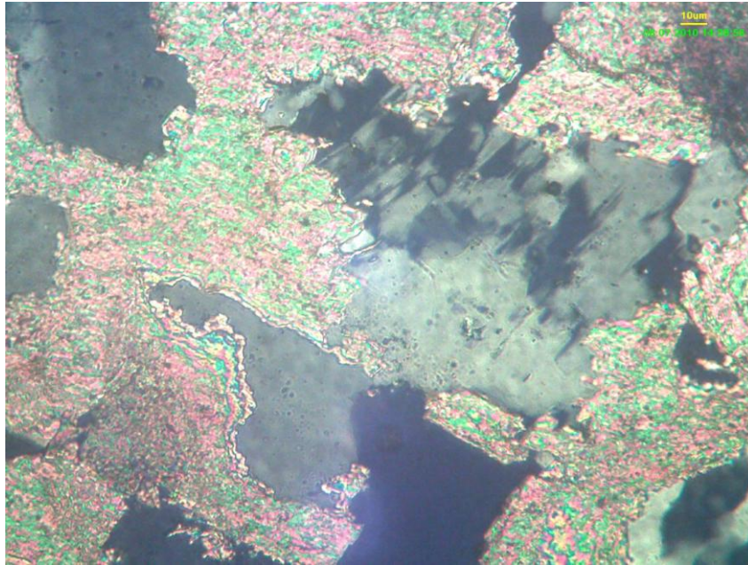
Рис. 2 – Корозія уламків і цементу пісковиків світи C_2^3 кальцитом (шл. 38065, св. Б-4728, гл. 430,15 м, шахта Ровеньківська 1-2, Довжано-Ровенецький р-н)
