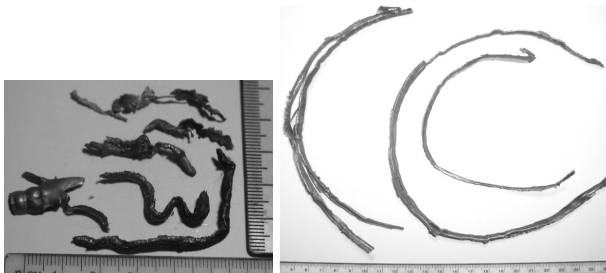
Рис. 2 - Осколки, образующиеся в результате срабатывания кумулятивных зарядов
