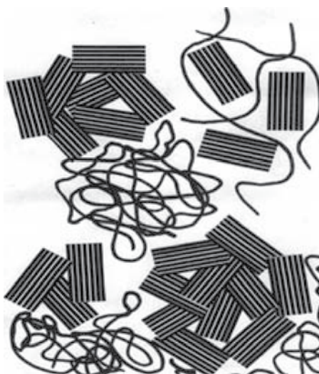
Рис. 1. Схематическое изображение структуры ГПК
