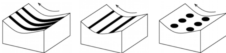
Рис. 1. Схеми лазерного гартування. а – паралельно, б – перпендикулярно до напрямку тертя, діаметр плями лазерної обробки 3 мм, швидкість пересування лазерного променя 0,5 м/хв, в – дискретна обробка променем лазера діаметром 3 мм.
