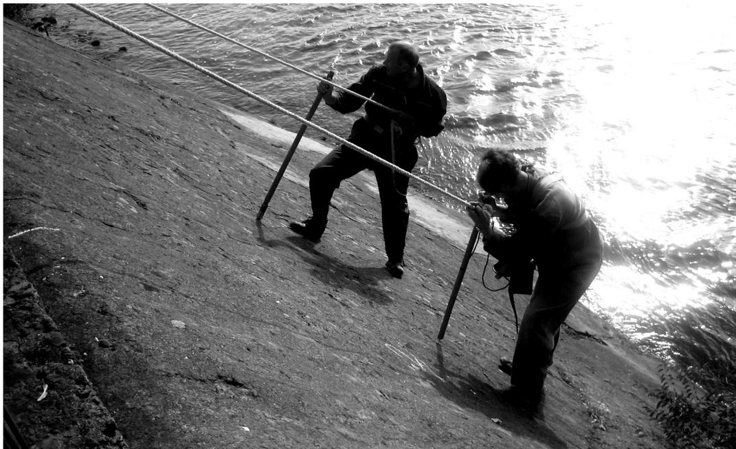
Рис. 2 – Выполнение виброакустической диагностики по горизонтальному профилю на береговом откосе водохранилища, укрепленном бетонным покрытием
