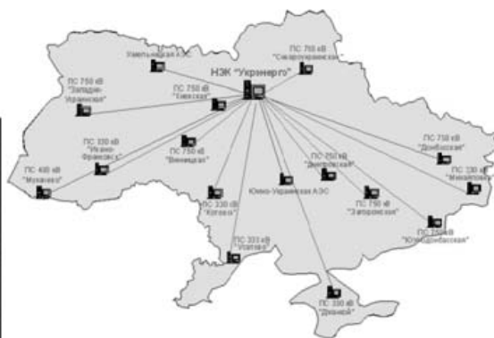
Рис. 9. Апаратура для моніторингу перехідних режимів (МПР) в Об'єднаній енергосистемі України (ліворуч знизу). Карта першої черги розміщення в Україні засобів МПР на енергооб'єктах 330—750 кіловольт (праворуч)
