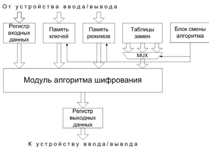
Рис. 5. Структурная схема операционного блока для случая динамической модификации разновидностями
