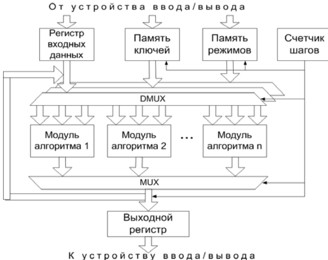
Рис. 3. Структурная схема операционного блока для случая каскадного шифрования
