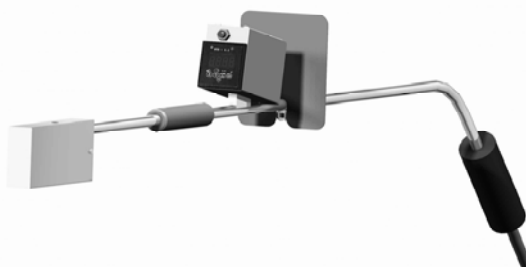
Рис. 5. Термозонд з вольфрамрениєвою термопарою для короточасного вимірювання температури в розплаві металу.
