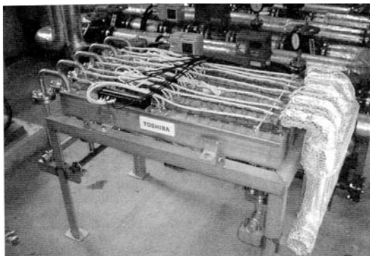
Рис. 8. Демонстраційна система генерування потужності класу 150 Вт, що використовує гарячі джерела.
