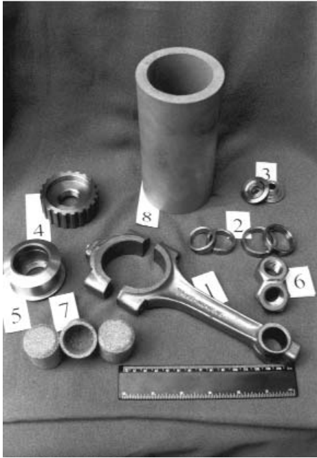
Рис. 11. Титанові деталі, отримані методом СПК з порошку гідрида титану: 1 – шатун, 2 – седла впускного і випускного клапанів, 3 – тарелка пружини клапана, 4 – шестерня, 5 – ролик, 6 – гайка, 7–8 – фільтри системи підготовки палива
