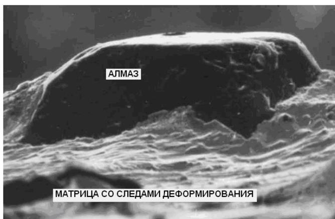
Рис. 1. Характерный вид износа материала матрицы алмазной буровой коронки
