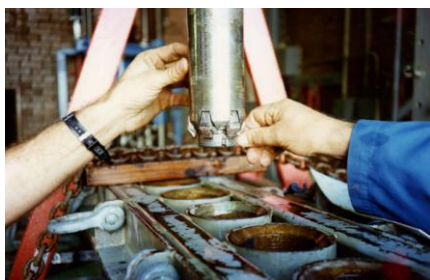
Рис. 2. Общий вид колонкового набора СРК-76 на стенде фирмы «Терра Тек» (США)
