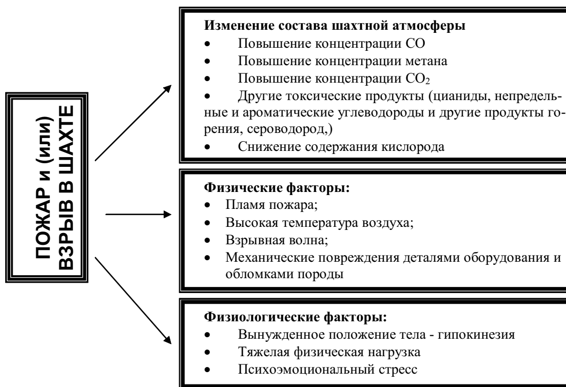
Рис. 2. Вредные и опасные для здоровья факторы, действующие на организм горнорабочих при пожарах и взрывах в шахте
