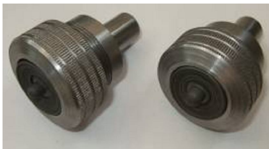
Рис. 4. Общий вид инструментов, изготовленных из материала ВК10КС
