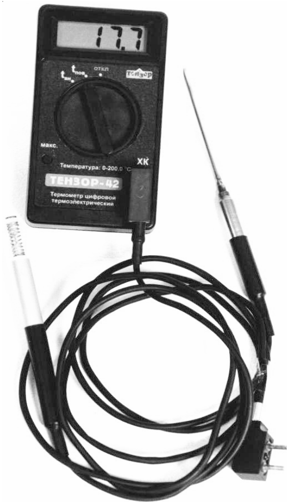
Рис. 9. Зовнішній вигляд термометра «Тензор-42»
