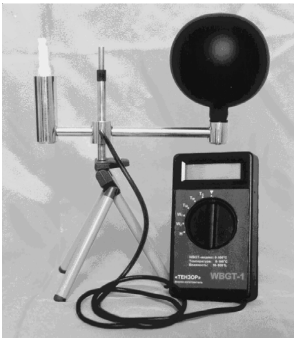
Рис. 8. Зовнішній вигляд кульового термометра «Тензор-41»
