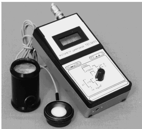
Рис. 7. Загальний вигляд фотометра TEC 0693.
