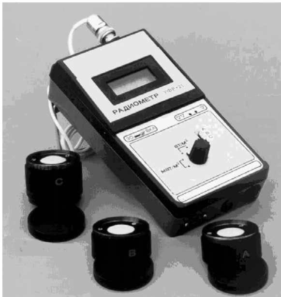
Рис. 5. Зовнішній вигляд радіометру УФР-21.
