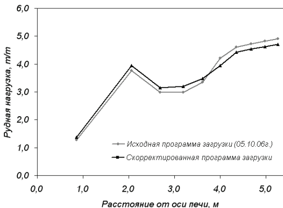
Рис.4. Распределение рудных нагрузок по радиусу при загрузке ДП №9 по исходной и скорректированной программе загрузки.
