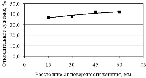
Рис. 7. Зависимость относительного сужения от глубины отбора образцов.
