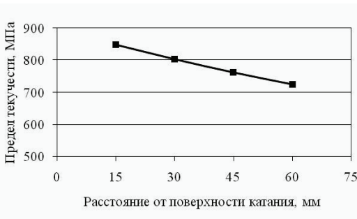
Рис. 4. Зависимость предела текучести от глубины отбора образцов.
