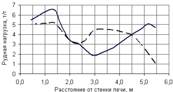
Рис.3. Распределение рудных нагрузок по радиусу колошника ДП №5. ————— без учета деформации кокса; — — — — с учетом деформации кокса;
