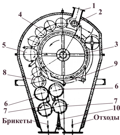
Рис.1. Валковый пресс для брикетирования угля.
