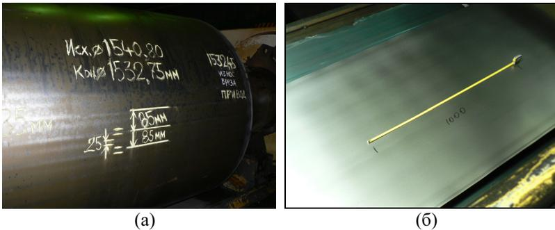
Рис.1. Периодические дефекты на поверхности опорного валка (а) и полосы (б)
