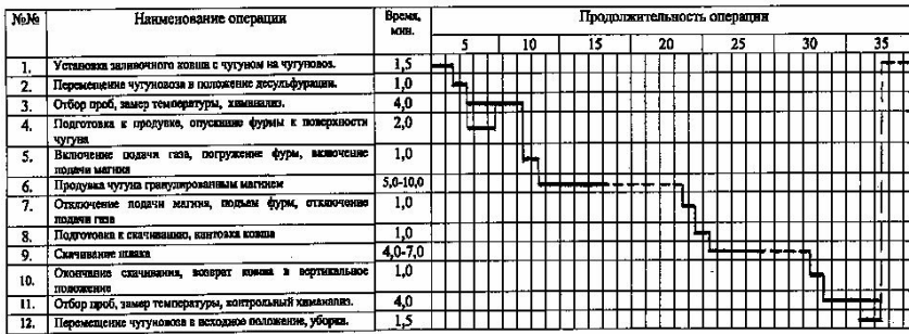
Рис.4. Уплотненная циклограмма работы оборудования отделения десульфурации чугуна в заливочных ковшах МК "Азовсталь" с фурмой улучшенной конструкции.
