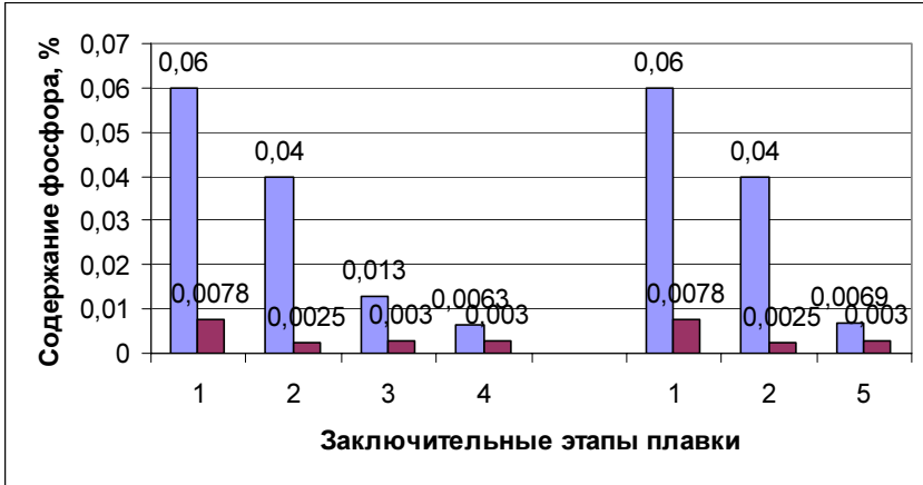
Рис.6. Изменение содержания фосфора в металле по заключительным этапам плавки.
