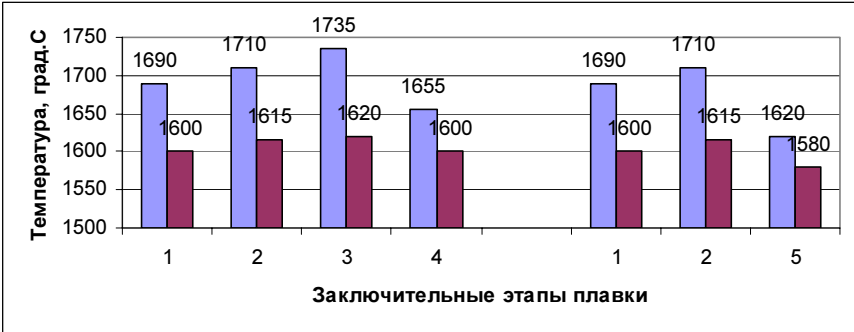
Рис.1. Изменение температуры металла по заключительным этапам кислородно-конвертерной плавки.
