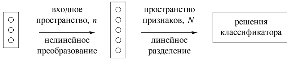
Рис. 1. Схема преобразования входного вещественного пространства
