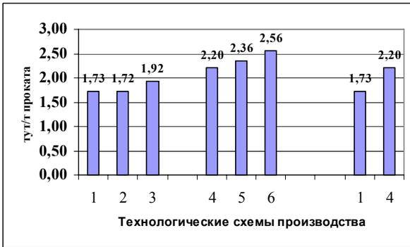
Рис.7. Расход энергоресурсов при различных схемах производства металлопродукции. Технологические схемы производства: 1. ДП – К – МНЛЗ – Сорт; 2. ДП – К – Из – Сорт; 3. ДП – М – Из – Сорт; 4. ДП – К – МНЛЗ – Лист; 5. ДП – К – Из – Лист; 6. ДП – М – Из – Лист. Обозначения:
