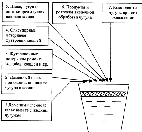
Рис.1. Принципиальная схема источников образования шлаков в чугуновозных и транспортных ковшах
