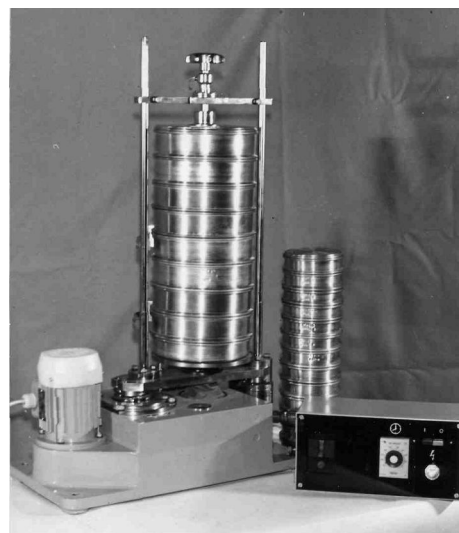
Рис. 3. Общий вид вибросита конструкции ИСМ НАН Украины
