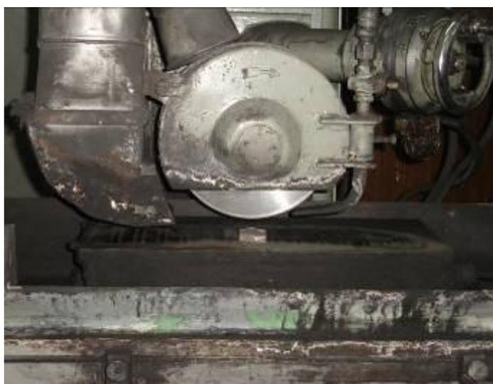
Рис. 2. Общий вид станда для исследования износостойкости образца на базе плоскошлифовального станка
