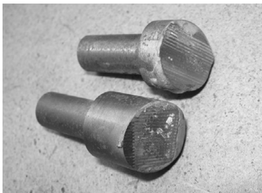
Рис. 3. Однослойные правящие карандаши до нанесения покрытий.
