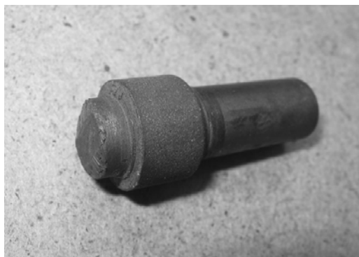
Рис. 1. Правящий карандаш типа “Славутич” до нанесения покрытия.
