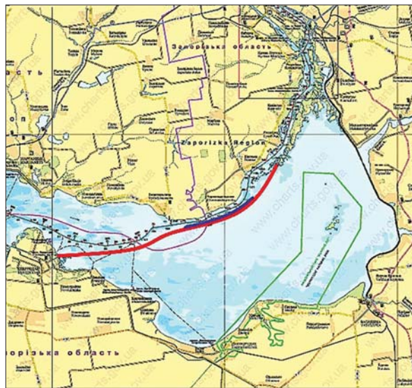
Рис. 13. Схема одамбування мілководної частини Каховського водосховища з метою створення квазіприродних лучних екосистем на місці Великого Лугу
