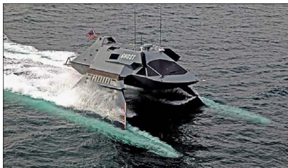
Рис. 15. Проект судна з малою площею ватерлінії катамаранного типу з кавітуючою підводною частиною
