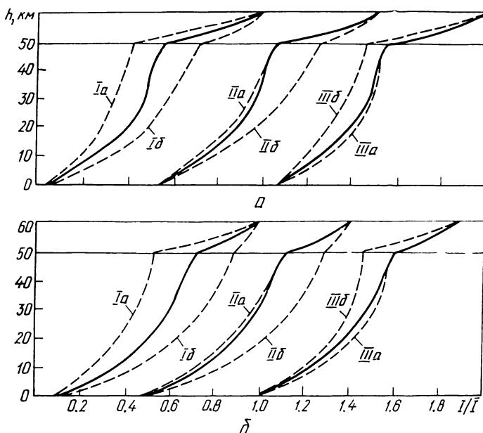
Зависимость интенсивности излучения от высоты в атмосфере Венеры по данным СА «Венера-13» (*a*) и «Венера-14» (*b*). Сплошные линии — данные измерений для  $\lambda=0.620$  мкм, полученные в [6]; штриховые — найденные высотные профили для различных вариантов возможного состояния атмосферы. Для каждого из рассмотренных случаев сделан сдвиг по оси абсцисс на пять (*a*) и на четыре (*b*) деления
