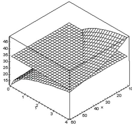
Рис. 5. Расчет области реальных значений длины трещины при  $H = 1200\text{м}$ ,  $P_c = 34\text{МПа}$
