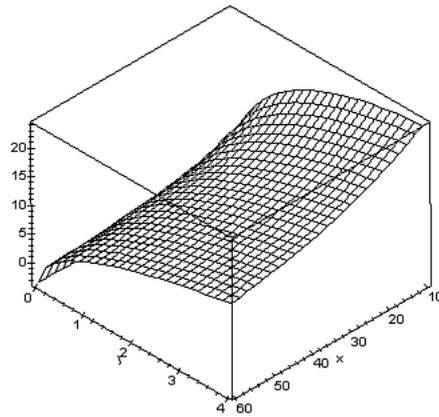
Рис. 3. Давление в концевой области трещины при  $P_c = 24\text{МПа}$ ,  $H = 800\text{м}$
