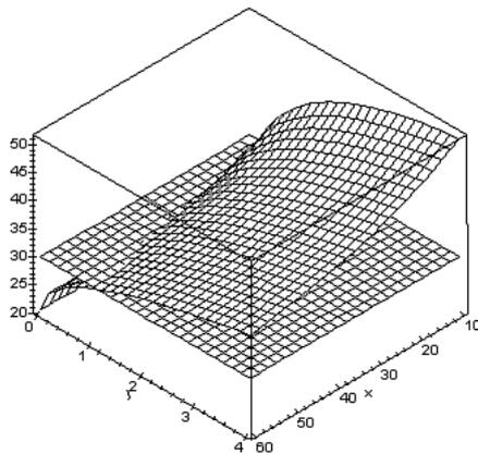
Рис. 4. Расчет области реальных значений длины трещины при  $H = 1200\text{м}$ ,  $P_c = 30\text{МПа}$
