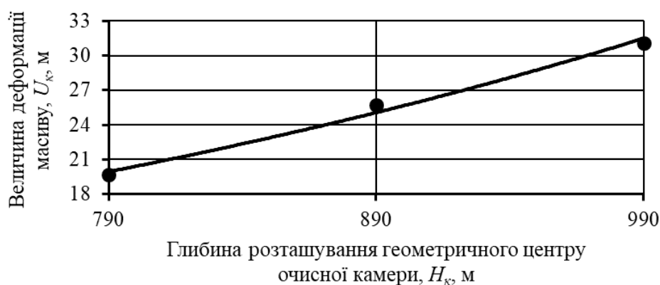
Рисунок 4. Графік залежності зміни величини деформації масиву гірських порід лежачого боку від глибини закладання камер другої черги відпрацювання
