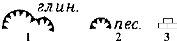
Рис. 3. Умовне позначення кар'єрів на топографічних картах (1 — глиняний, 2 — піщаний, 3 — торф'яні розробки)
