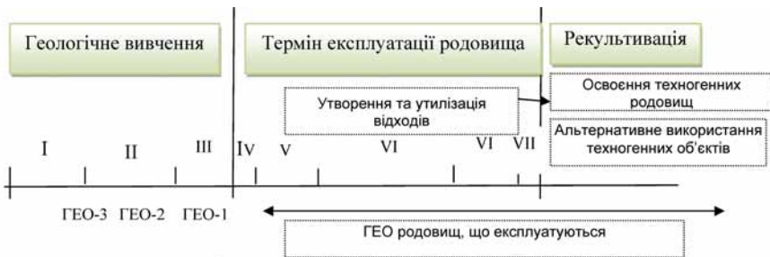
Рис. 2. Типові складові циклу геологічного вивчення та освоєння родовищ корисних копалин
