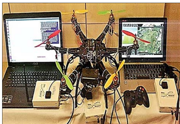
Рис. 4. Тестова платформа для апробації алгоритмів виявлення атак на систему навігації БпАК
