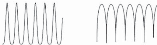
Рис. 5. Якісні відмінності шорсткості поверхні, сформованої звичайним інструментом (зліва) та інструментом з адаптивних полімерних композитів
