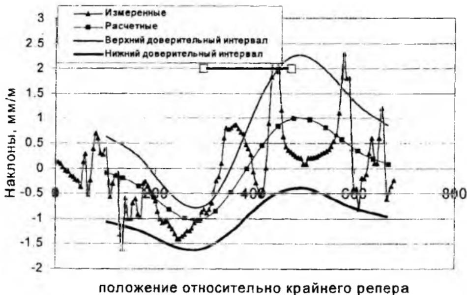
Рис. 6. Распределение наклонов в мульде сдвижений.
