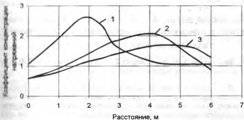
Рис. 2. Изменение напряжений в краевой части угольного пласта (целика) в зависимости от времени: 1 - после ее прохождения, 2 - через 2 суток, 3 - через 140 суток.
